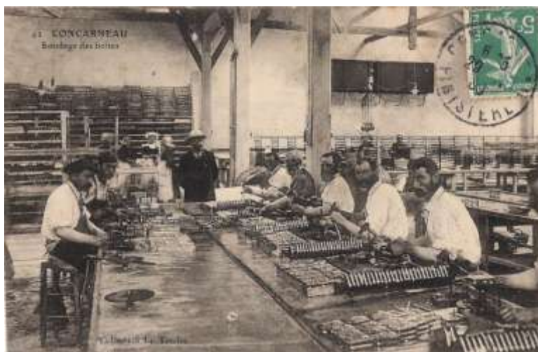
carte postale - le soudage des boîtes par les ferblantiers
